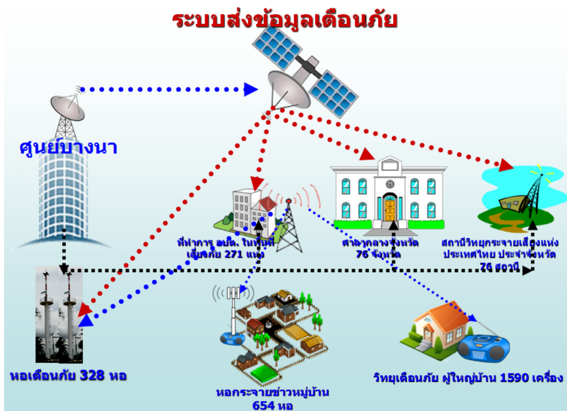
รูปที่ 6.3 ระบบส่งข้อมูลเตือนภัยของศูนย์เตือนภัยพิบัติแห่งชาติ
