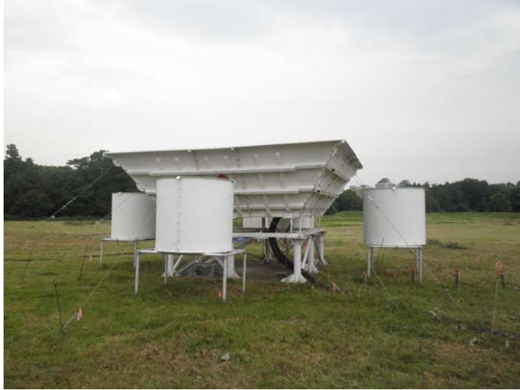
รูปที่ 2.1.2 ระบบตรวจวัดโครงสร้างกระแสลมชั้นบนแบบต่อเนื่อง (Wind Profiler)
