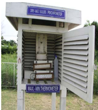
รูปที่ 4.1.1-1 เรือนเทอร์โมมิเตอร์ (Thermometer Screen)
