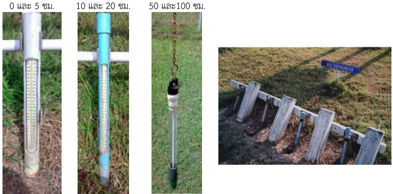
รูปที่ 4.1.1-6 เทอร์โมมิเตอร์ใต้ดิน (Soil Thermometers) ที่ระดับความลึกต่างๆ
