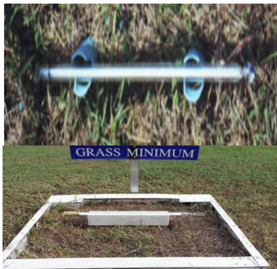
รูปที่ 4.1.1-5 เทอร์โมมิเตอร์ต่ำสุดยอดหญ้า
